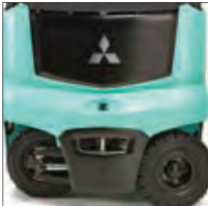
Hinterachse um 100 Grad lenkbar
